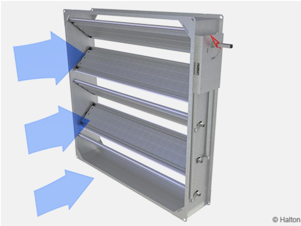
Die Halton UTK-Jalousieklappen werden zum Schließen, zur Einstellung oder zur Regelung der Luftströme in Kanälen eingesetzt. In geschlossener Position entspricht die Leckluft rate der Halton UTK-Klappe Klasse 1 in Übereinstimmung mit dem EN1751-Standard. In geöffneter Position liegen die Lamellen in Strömungsrichtung und verursachen keinen signifikanten Druckverlust.
